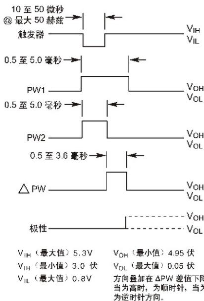
电压输出兼容 TTL, 每种输出可驱动一个低功耗肖特管或多个 CMOS 设备。
